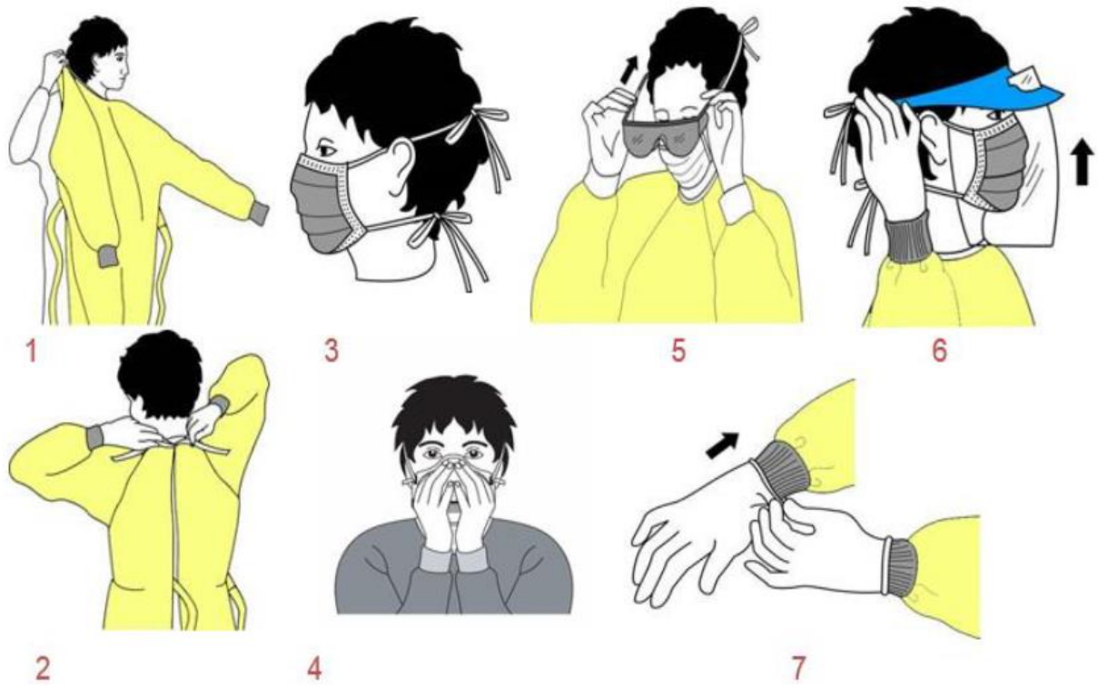
Figura 9. Secuencia correcta para la colocación de los equipos de protección personal.
